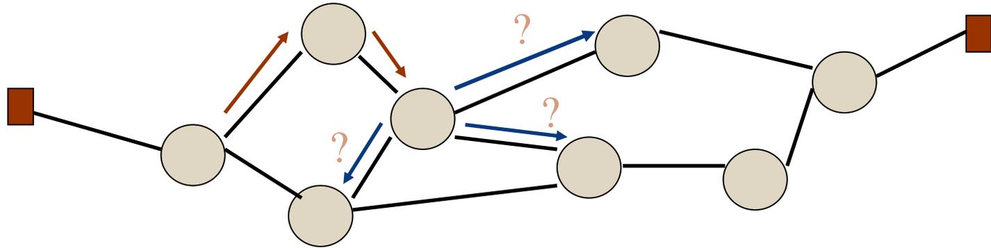
A chaque nœud correspond un routeur contenant une table de routage et mettant en place des algorithmes permettant l'acheminement des paquets dans Internet et éventuellement la mise à jour des tables automatiquement.
