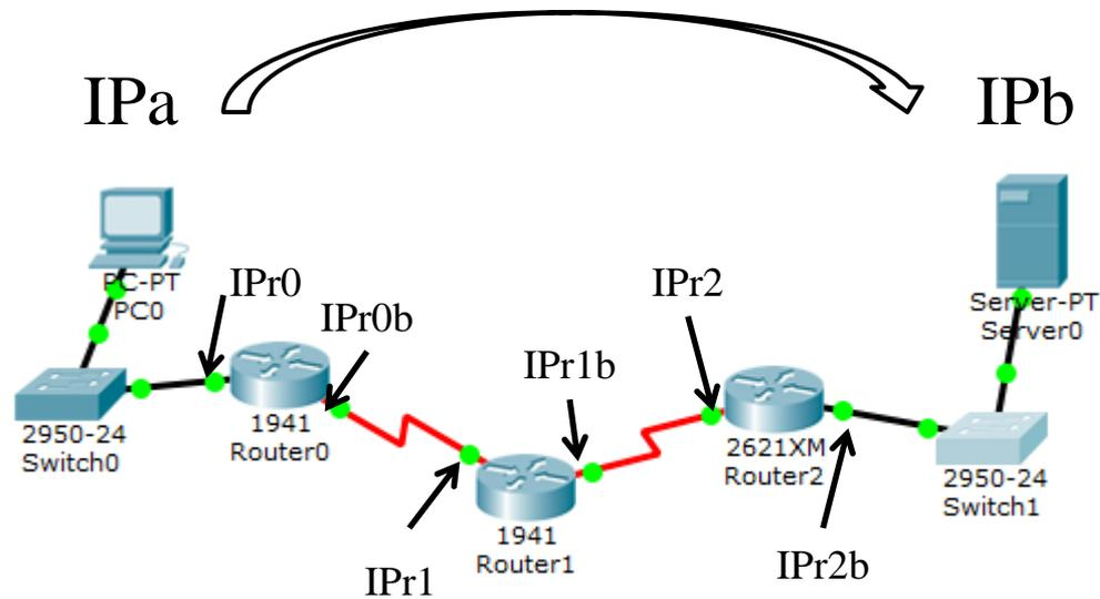
4 réseaux - (Ipa et IPr0) (IPr0b et IPr1) - (IPr1b et IPr2) - (IPr2b et Ipb)
