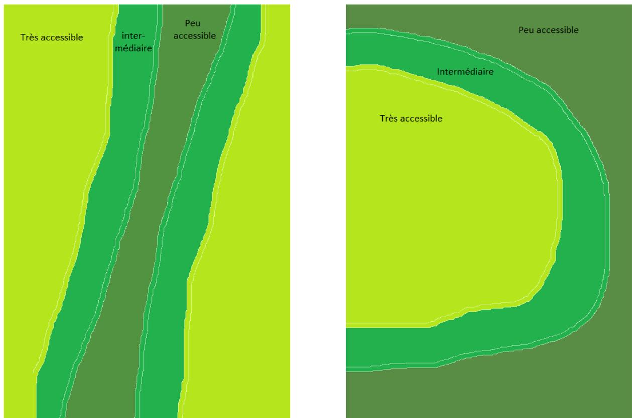
Figure 15 : Cartographie de l'accessibilité des zones de l'écran tactile d'une tablette sous différentes conditions d'utilisation
